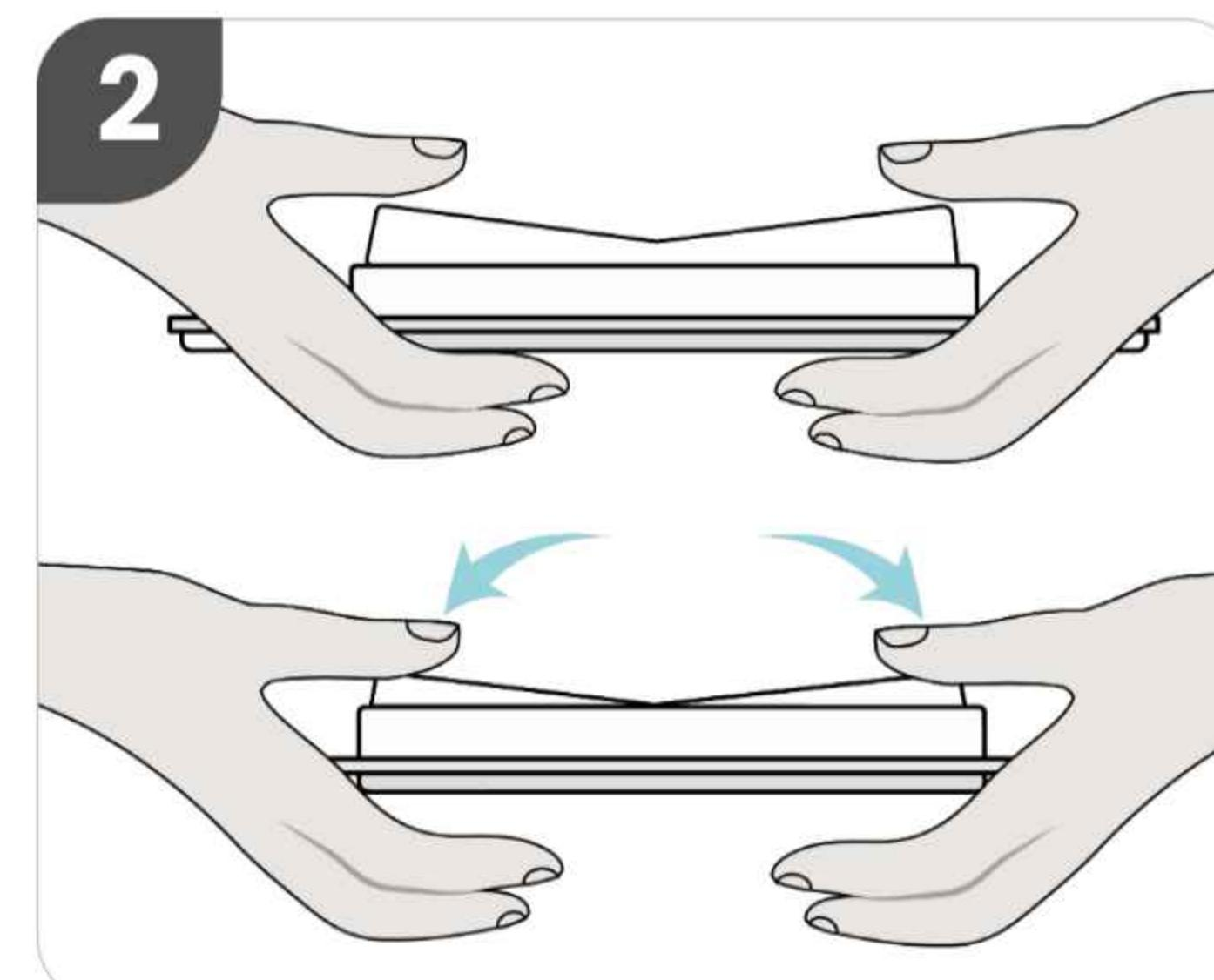
**Apriete y suelte ambos extremos del interruptor simultáneamente.** Ambos extremos DEBEN presionarse al mismo tiempo para enviar la señal de emparejamiento al controlador de potencia.
