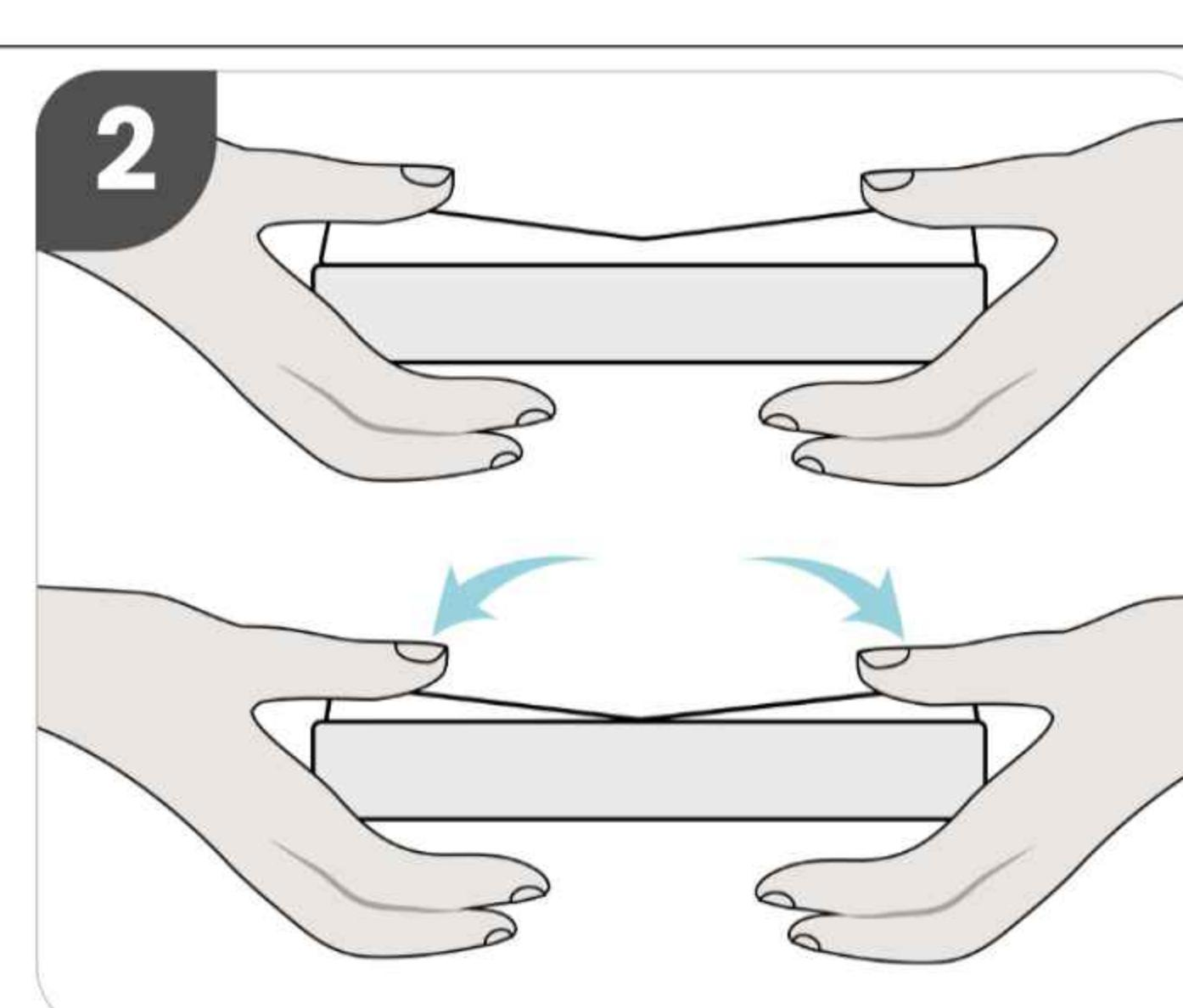
Apriete y suelte ambos extremos del interruptor simultáneamente. Ambos extremos DEBEN presionarse al mismo tiempo para enviar la señal de emparejamiento al controlador de potencia.
