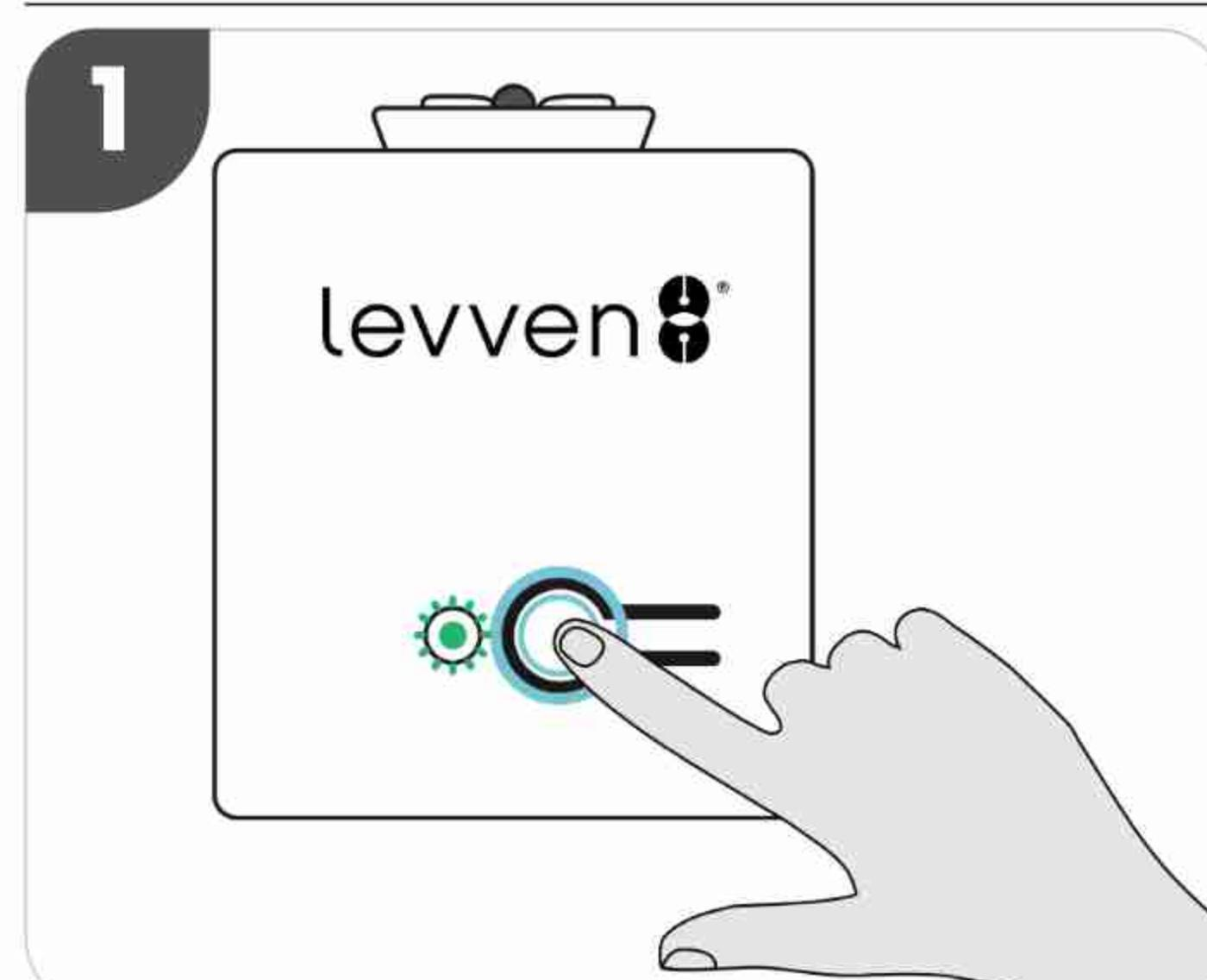
Appuyez et relâchez le bouton d'appairage du contrôleur pour lancer l'appairage. La LED de ce contrôleur clignotera en vert. Le mode appairage est actif pendant 60 secondes. Si aucune demande d'appairage n'est reçue dans les 60 secondes, le contrôleur quitte le mode d'appairage.
