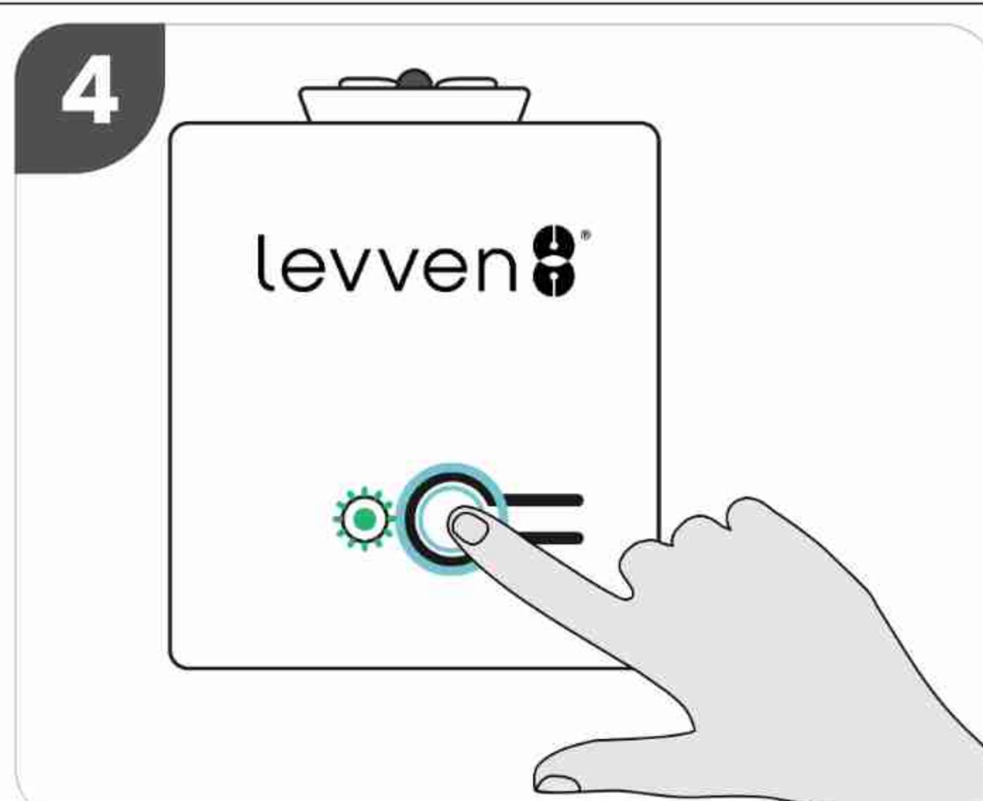
Appuyez et relâchez le bouton d'appairage du contrôleur pour terminer l'appairage. La LED clignote 3 fois en vert si l'appairage est réussi; sinon, il clignote en rouge. Si le couplage a échoué, recommencez à partir de l'étape 1.
