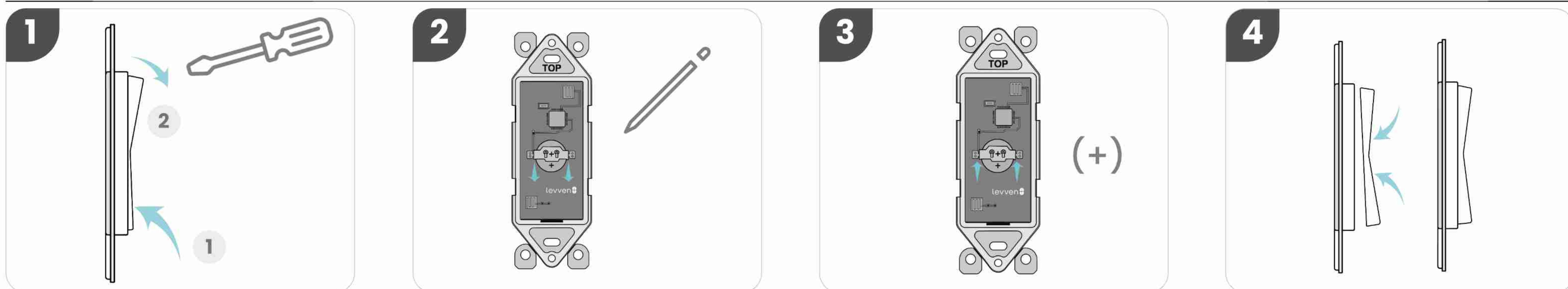
Mantenga presionada la parte inferior o superior del interruptor basculante. Utilice un destornillador o una herramienta similar para quitar el interruptor basculante del interruptor y revelar el compartimento de la batería.
