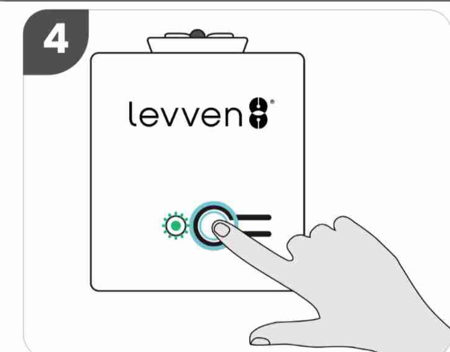
Appuyez et relâchez le bouton d'appairage du contrôleur pour terminer l'appairage. La LED clignote 3 fois en vert si l'appairage est réussi; sinon, il clignote en rouge. Si le couplage a échoué, recommencez à partir de l'étape 1.
