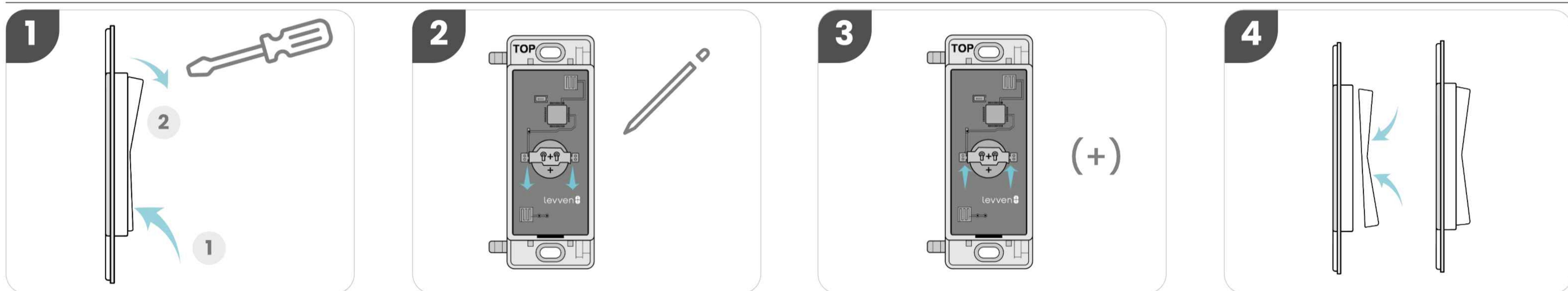
**Appuyez et maintenez enfoncé le bas ou le haut de la bascule de l'interrupteur. Utilisez un tournevis ou un outil similaire pour soulever la bascule de l'interrupteur afin de révéler le compartiment de la batterie.**
