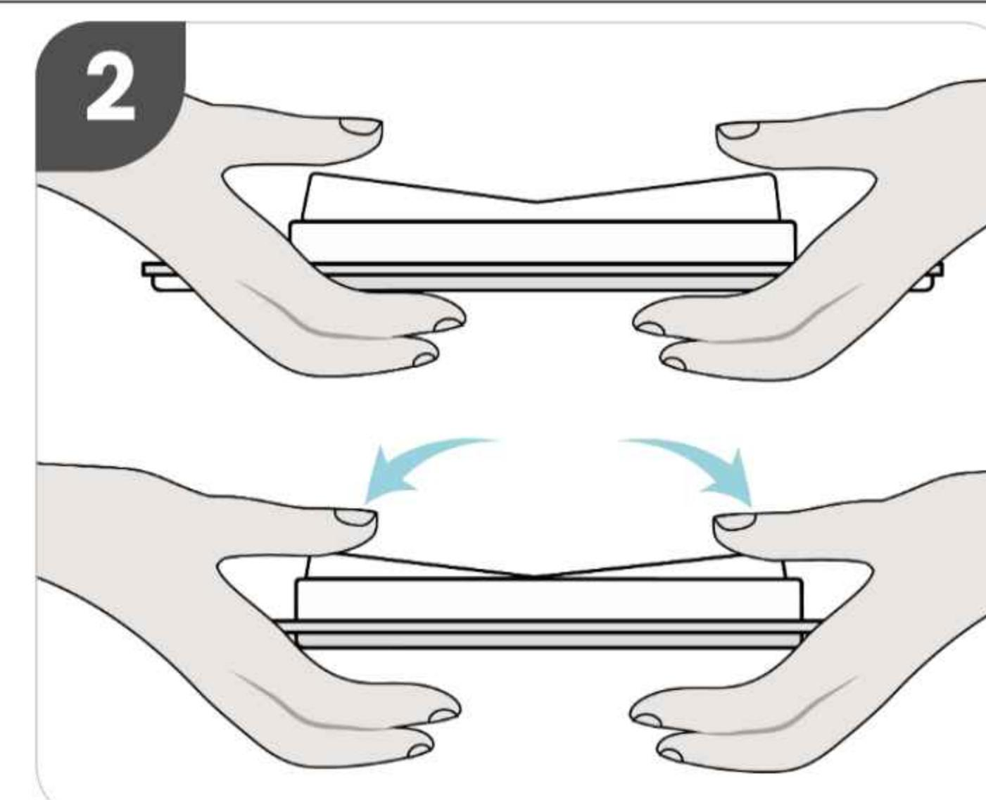
Appuyez et relâchez simultanément les deux extrémités de l'interrupteur. Les deux extrémités DOIVENT être enfoncées en même temps pour envoyer le signal d'appairage au contrôleur de puissance.
